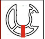
Nýtují se krajní tyčky a dvě uprostřed mezi sloupky, zbylé se lepí silikonem
